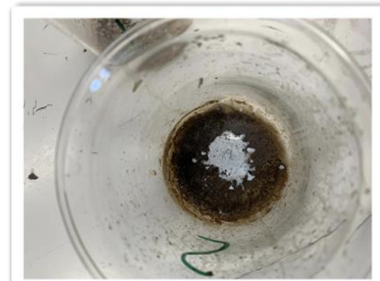
Nachweis von Chlorid-Ionen durch Silbernitrat Lösung
