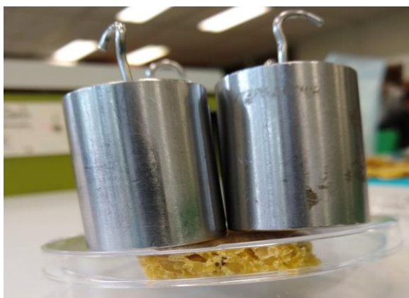
Messreihe 1: Messung der Dicke mit Gewichtsbelastung
