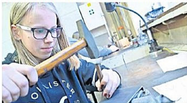
Svenja (13) vom Erich-Kästner-Gymnasium schlägt kleine Vertiefungen in das Metall. Später setzt sie dort den Bohrer an.
